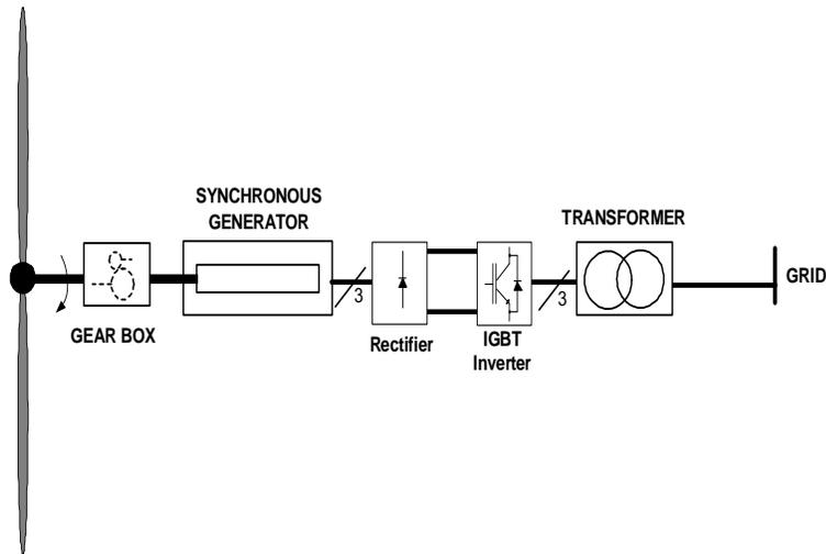
(d) Type 4 Wind Turbine-Generator: Full Power Conversion
